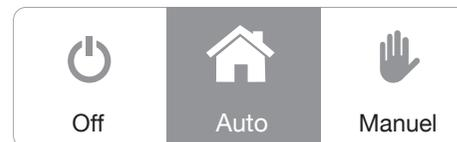
**Off** : En mode Off, tado° ne chauffe que lorsque la température ambiante descend en dessous de 5°C pour éviter des dommages dus au gel.
