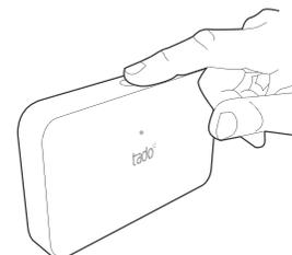
Le kit d'extension a un bouton sur le dessus et une lumière LED blanche qui brille à travers la façade du boîtier. La lumière LED clignote doucement lorsque le kit d'extension est activé
