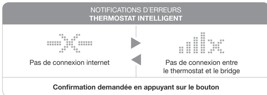
Les notification sont différentes si tado° fonctionne avec le kit d'extension
