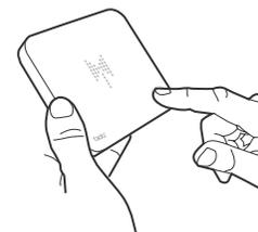
Le thermostat intelligent tado° possède une interface utilisateur qui est activée en pressant le bouton en bas à droite de l'appareil. La température actuelle s'affiche en premier. Le bouton en bas à droite de l'appareil permet de naviguer dans le menu. En pressant le bouton une seconde fois, l'écran mode apparaît.
