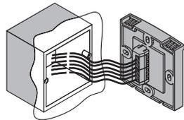
Les bornes sont prévues pour recevoir des fils de section entre 0,32 et 2,1 mm<sup>2</sup>.
