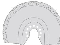
Lâmina de carboneto para remover argamassa.
