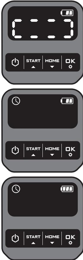
La tondeuse robot se met à se déplacer vers la station de charge.
