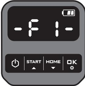
La tondeuse robot reviendra automatiquement à la station de charge lorsque le capteur de pluie est mouillé. L'écran affichera un code d'information « F1 ».
