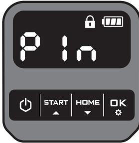
L'écran affichera « PIN XXXX » (votre nouveau code PIN) si le réglage a réussi. Si le réglage échoue, il affichera « PIN XXXX » (code PIN d'origine).
