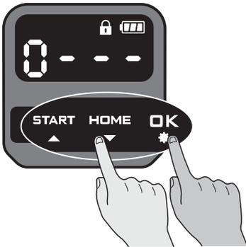
Le voyant **🔒** s'allume et reste allumé, le premier chiffre clignote. Saisir un PIN à 4 chiffres pour déverrouiller la tondeuse robot.
