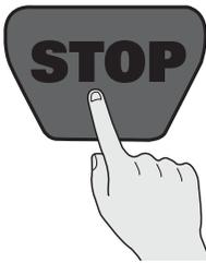
Appuyez sur le bouton **STOP** (3) pour arrêter la tondeuse robot si elle n'est pas en mode « veille » ni « repos ». L'écran affiche « **STOP** » et passe en mode « repos ».
