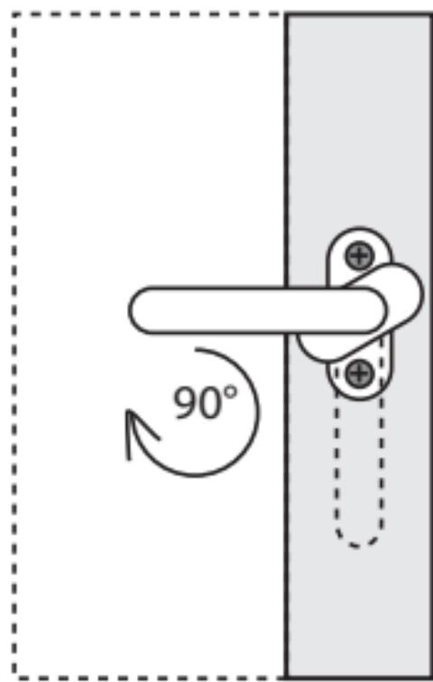
Positionner la poignée dans le profil de fenêtre grâce aux 2 plots  $\varnothing$  10 mm.
