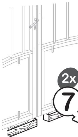
Afin de garantir une fermeture et un verrouillage corrects du portail, fixez les battants du portail à l'aide de brides de sécurité afin de les maintenir dans une position horizontale et verticale identique. Laissez les brides en place pendant au moins 48 heures jusqu'à ce que le béton soit entièrement pris.
