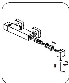
Appliquez une graisse spéciale robinetterie puis remontez la cartouche thermostatique à l'aide de la clé plate et revissez la vis de blocage sous le corps du mitigeur. Procédez à un réglage de la température avant de remonter la poignée en suivant les instructions du paragraphe ci-dessous (Réglage de la température). En effet, un contrôle de la température de référence 38°C est nécessaire suite à toute opération d'entretien de la cartouche thermostatique.
