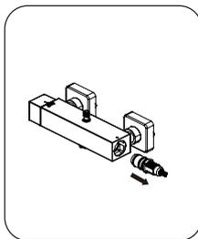
Dévissez la vis de blocage sous le corps du mitigeur. A l'aide d'une clé plate, retirez la cartouche thermostatique. Pour retirer le tartre au sein de la cartouche thermostatique, plongez-la dans une solution d'eau chaude vinaigrée à 5% (vinaigre blanc) afin de dissoudre le tartre, qui réduit les performances du mitigeur thermostatique.
