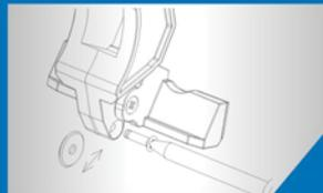
Enlevez la molette et remplacez la par une nouvelle : modèle YG6X, Ø 22 x 6 x 2 mm.
