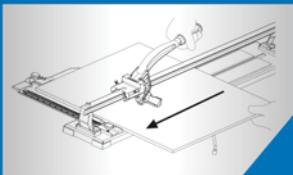
**Coupe Droite.** Marquez la ligne de coupe sur le carreau à l'aide d'un crayon. Rayez le carreaux en faisant rouler la molette sur le carreau vers l'avant, en pressant légèrement.
