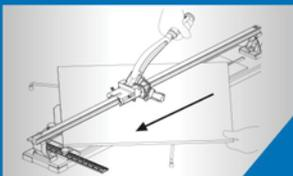
**Coupe diagonale.** Marquez la ligne de coupe sur le carreau à l'aide d'un crayon. Positionnez le guide d'angle sur l'angle souhaité. Positionnez le carreau contre le guide. Rayez le carreaux en faisant rouler la molette sur le carreau vers l'avant, en pressant légèrement.
