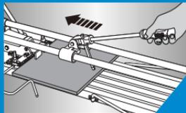
Rayer le carreau en faisant rouler la molette sur le carreau vers l'avant, en pressant légèrement.
