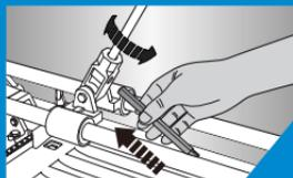
Insérez la molette et tourner la poignée pour la verrouiller en position de coupe
