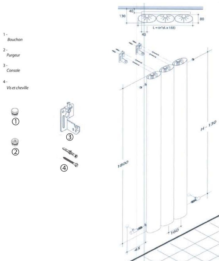
> Posez le radiateur avec les supports au mur afin de repérer les trous à percer.
