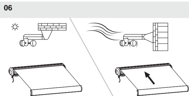
IMPORTANT: L'ANÉMOMÈTRE EST DÉJÀ RÉGLÉ ET PRÊT À ÊTRE UTILISÉ
