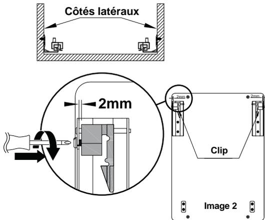
1. Si l'épaisseur des côtés de votre caisson est de 16mm, il n'est pas nécessaire de faire des ajustements..
