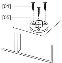
Marquez le bas du caisson à l'aide du gabarit [07] fourni. Percez les trous ainsi marqués et fixez le support de montage inférieur à l'aide de 3 vis [01].
