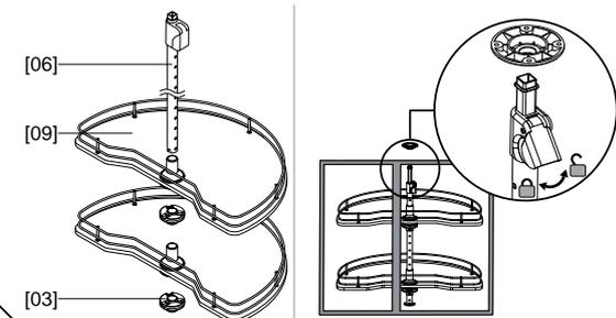
Montez les plateaux [09] et les plaques pivotantes [03] sur le poteau avant fixation dans le caisson. Positionnez le poteau dans la plaque de montage inférieure, puis ajuster le poteau à l'aide du dispositif en haut (comme indiqué ci-dessus) afin de le bloquer dans la plaque de montage supérieure.
