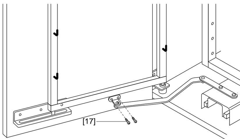
Positionnez et fixez le support du bras articulé inférieur sur la porte en veillant à ce que le bras reste horizontal.
