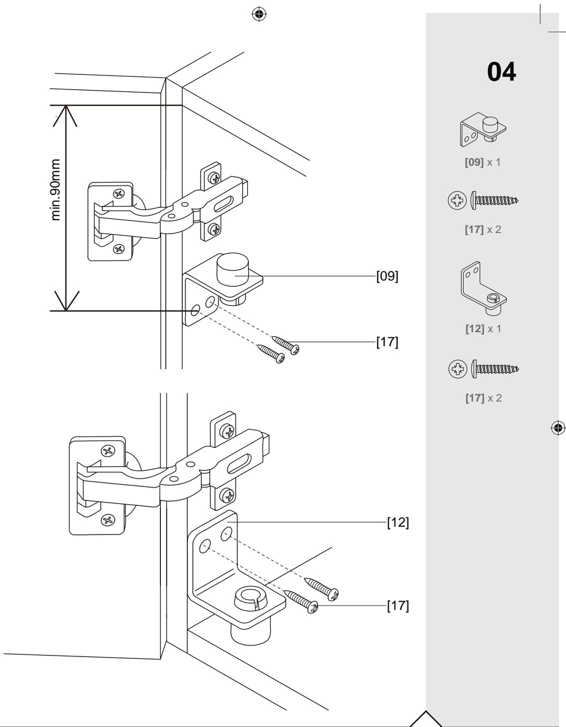
Fixez les pattes de fixation supérieures et inférieures de telle manière qu'elles affleurent parfaitement avec la façade avant du caisson. Assurez-vous que le support supérieur n'obstrue pas la fermeture de la charnière de porte
