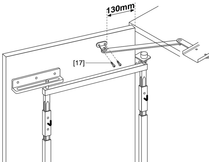
Positionnez et fixez le support du bras articulé supérieur en veillant à ce que le bras reste horizontal avant de visser le support.
