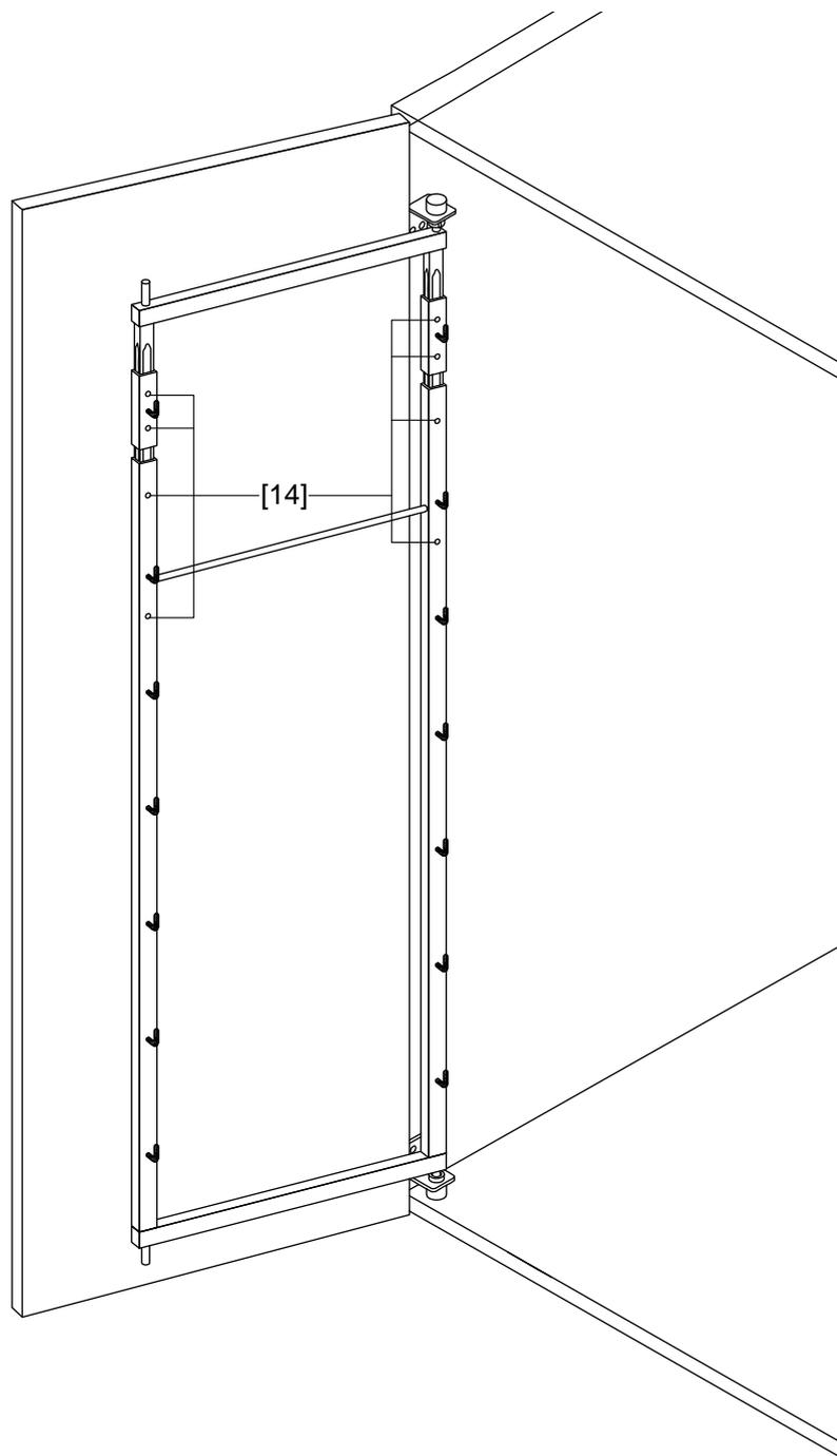
Montez le cadre de la porte dans les supports et réglez la hauteur du cadre à l'aide des vis.
