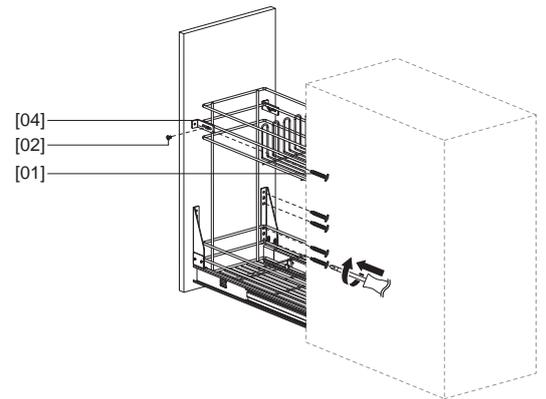
Fixez la porte et le support sur le panier à l'aide des vis [01] et [02].
