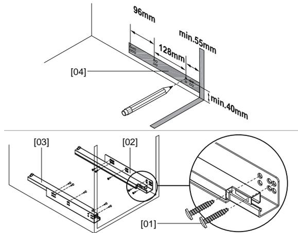
Marquer les positions des vis pour les glissières à gauche et à droite de votre caisson à l'aide du gabarit [4] fourni, puis fixer les glissières à l'aide des vis [01] fournies.
