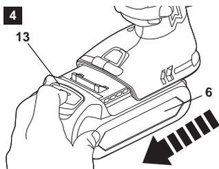
3. Pour monter la batterie **[6]**, alignez-la avec la base de la poignée puis faites-la coulisser jusqu'à ce qu'elle se verrouille en position. Vous devez entendre un déclic (fig. 5).
