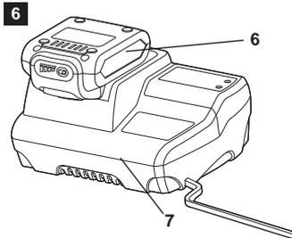
4. Le chargeur communique avec les circuits de la batterie afin d'évaluer l'état de sa charge.
