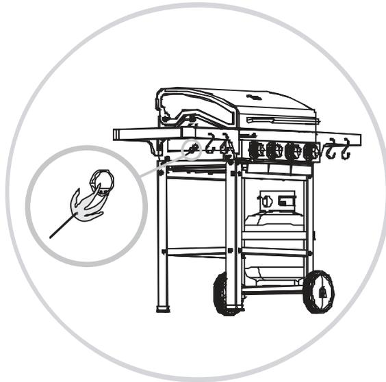
4. Appuyez sur le bouton de commande et tournez-le dans le sens inverse des aiguilles d'une montre pour le mettre sur grand feu.
