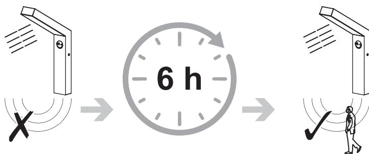
**EN Sensor override mode deactivates automatically after 6 h.****FR Le mode de contournement du capteur se désactive automatiquement après 6 h.****PL Tryb nadpisywania czujnika wyłącza się samoczynnie po 6 godzinach.****RO Modul ignorare senzor se dezactivează automat după 6 ore.**
