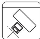
**EN** Mount the sensor perpendicular to the ground**FR** Monter le détecteur perpendiculairement au sol**PL** Zamontuj czujnik prostopadle do podłoża**RO** Montează senzorul perpendicular pe sol
