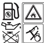
Coupez le moteur pendant le remplissage des réservoirs ! Le carburant est inflammable, éloignez toute flamme. N'ajoutez pas de carburant lorsque le moteur tourne.
