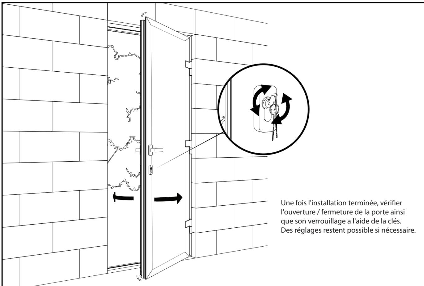
Une fois l'installation terminée, vérifier l'ouverture / fermeture de la porte ainsi que son verrouillage à l'aide de la clés. Des réglages restent possible si nécessaire.
