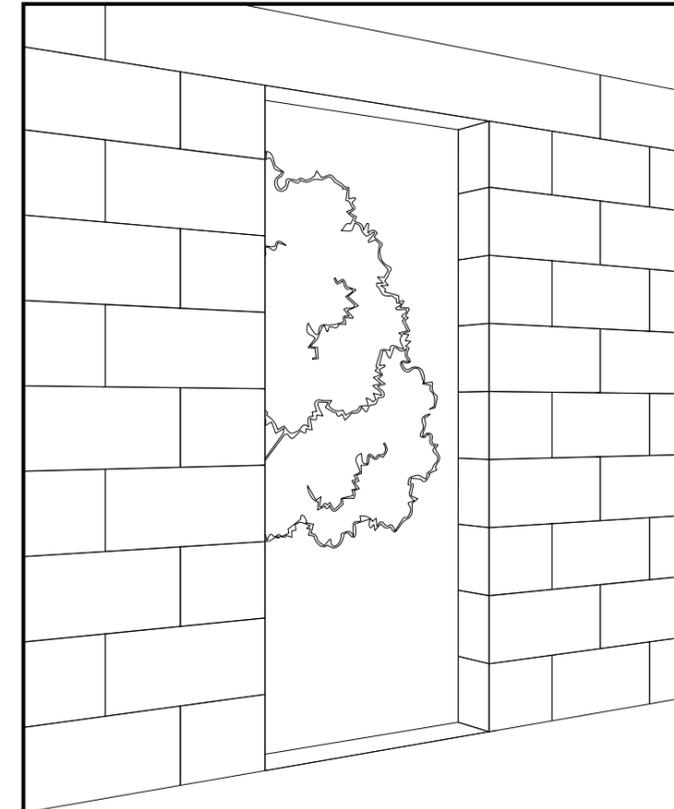
Vérifier le niveau de la maçonnerie à l'aide d'un niveau à bulle. La surface doit être plane et nettoyée. Si besoin, la rectifier.
