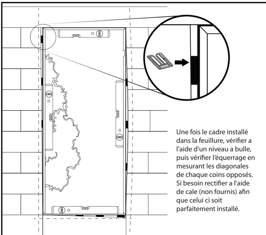
Une fois le cadre installé dans la feuillure, vérifier à l'aide d'un niveau à bulle, puis vérifier l'équerrage en mesurant les diagonales de chaque coins opposés. Si besoin rectifier à l'aide de cale (non fournis) afin que celui-ci soit parfaitement installé.
