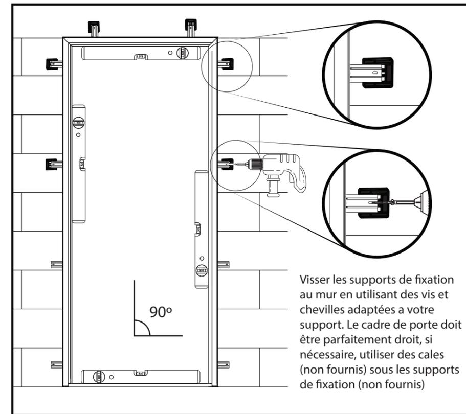
Visser les supports de fixation au mur en utilisant des vis et chevilles adaptées à votre support. Le cadre de porte doit être parfaitement droit, si nécessaire, utiliser des cales (non fournis) sous les supports de fixation (non fournis)
