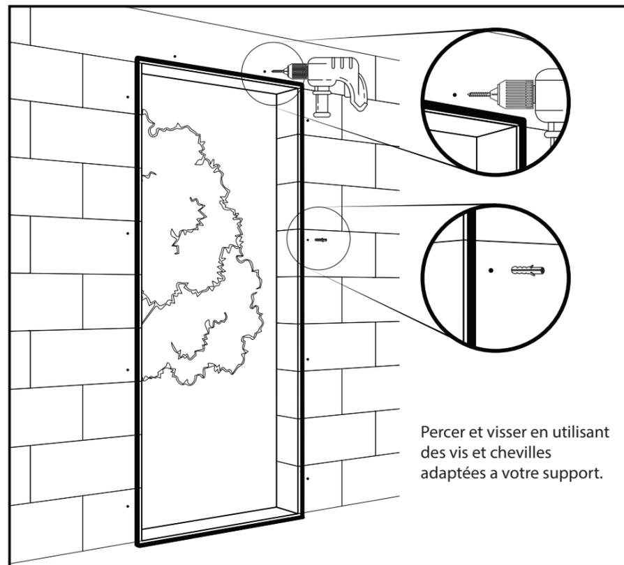
Percer et visser en utilisant des vis et chevilles adaptées à votre support.
