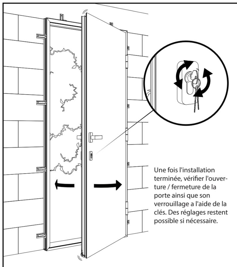
Une fois l'installation terminée, vérifier l'ouverture / fermeture de la porte ainsi que son verrouillage à l'aide de la clés. Des réglages restent possible si nécessaire.
