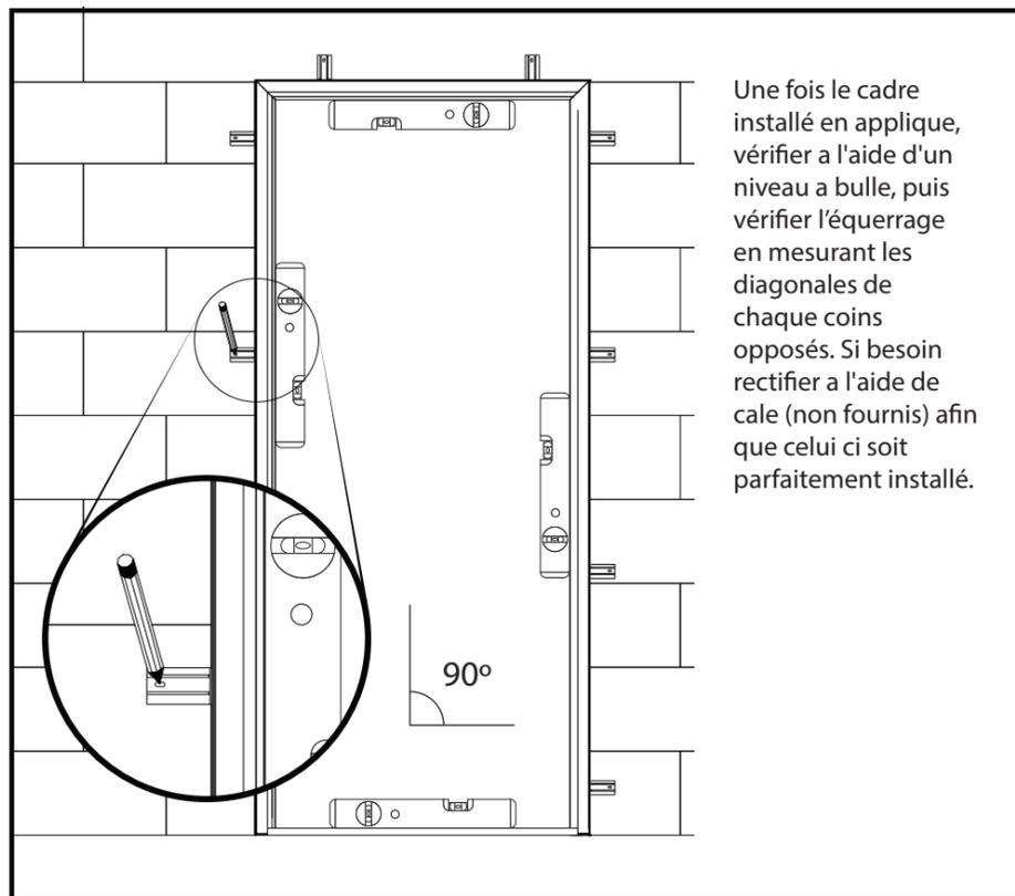
Une fois le cadre installé en applique, vérifier à l'aide d'un niveau à bulle, puis vérifier l'équerrage en mesurant les diagonales de chaque coins opposés. Si besoin rectifier à l'aide de cale (non fournis) afin que celui-ci soit parfaitement installé.
