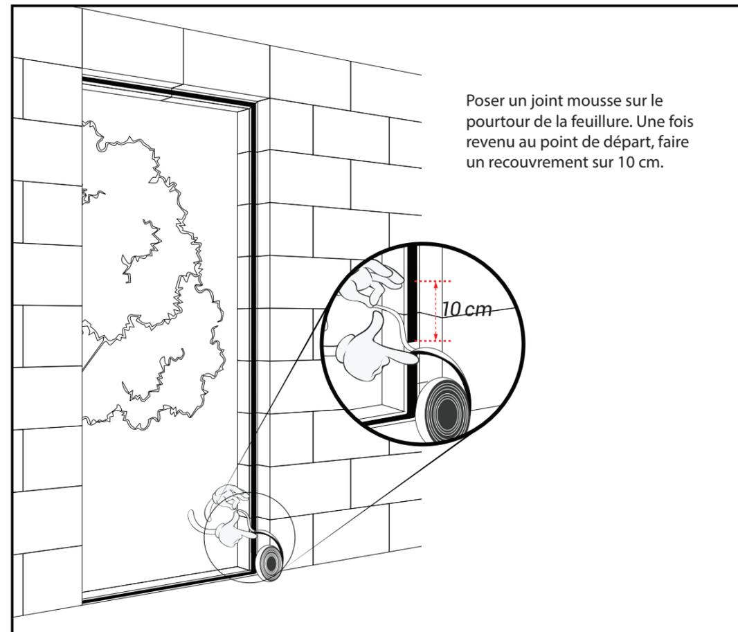
Poser un joint mousse sur le pourtour de la feuillure. Une fois revenu au point de départ, faire un recouvrement sur 10 cm.
