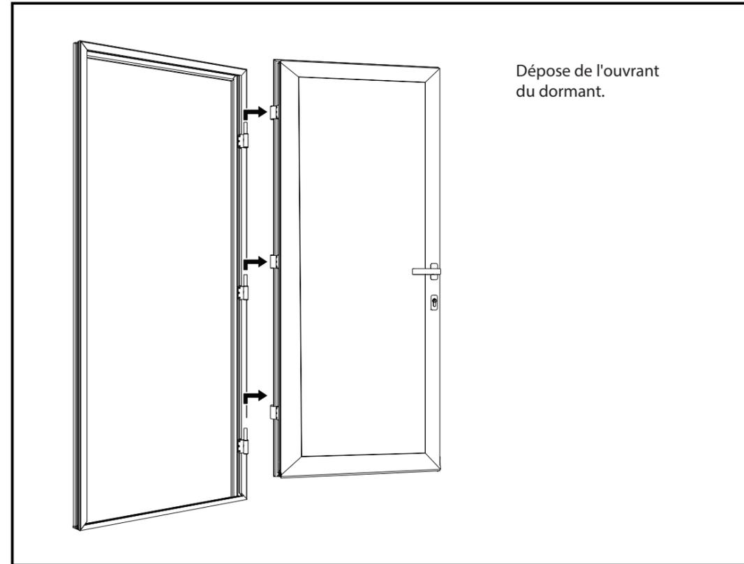
Dépose de l'ouvrant du dormant.
