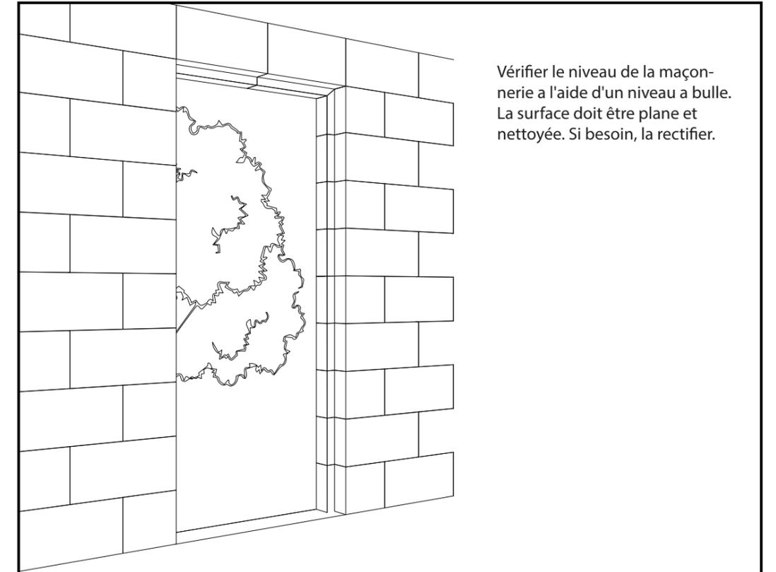
Vérifier le niveau de la maçonnerie à l'aide d'un niveau à bulle. La surface doit être plane et nettoyée. Si besoin, la rectifier.
