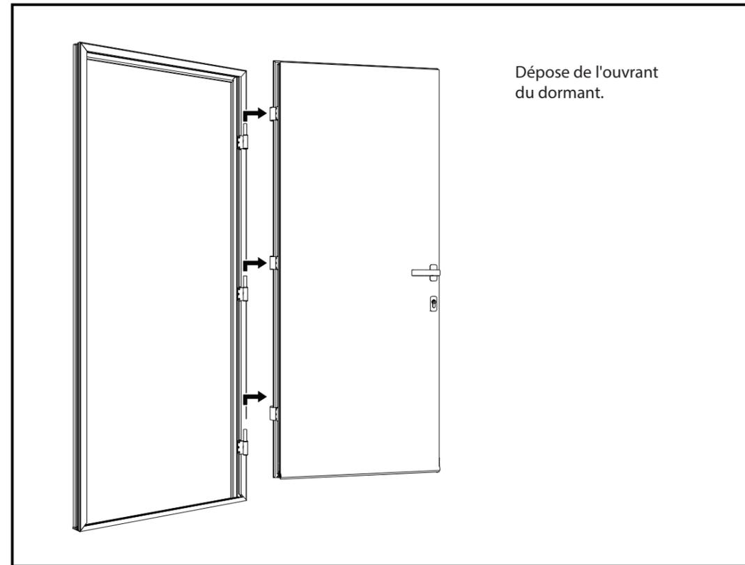
Dépose de l'ouvrant du dormant.
