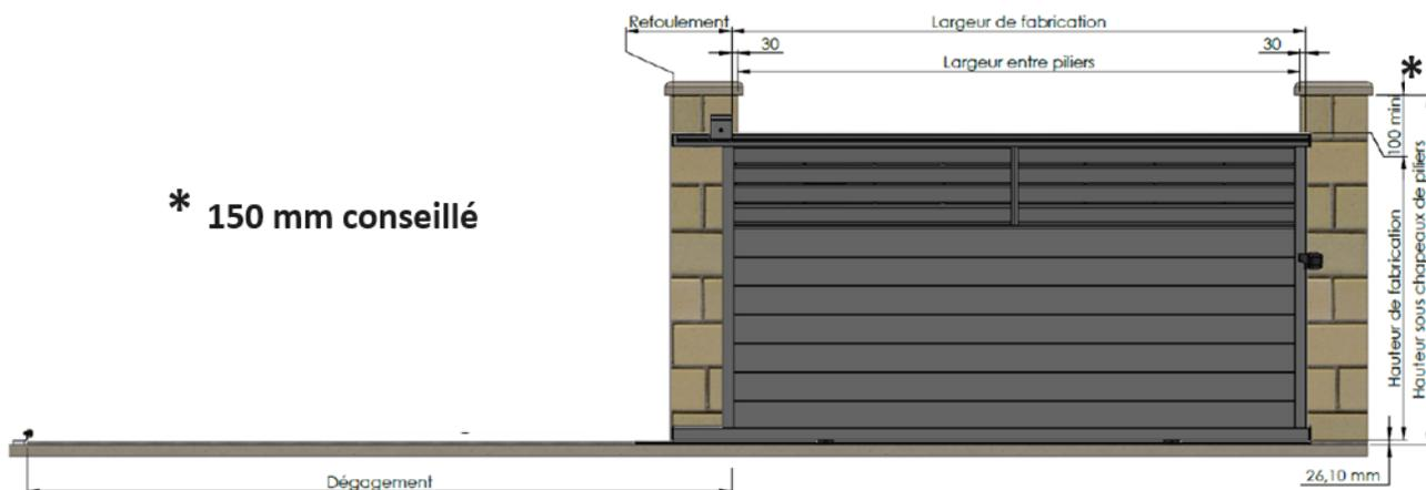
L'installation d'un portail s'effectue sur un seuil fini, stable, plat et rectiligne sur toute la surface de débattement du portail. La profondeur de la fondation doit répondre aux exigences climatiques (profondeur hors gel), géologique et géographique.
