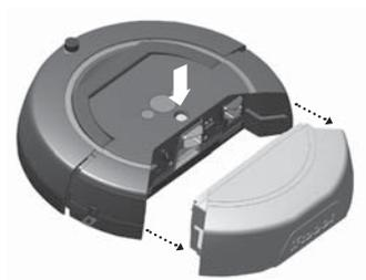
Appuyez sur le bouton de dégagement du réservoir pour retirer ce dernier. Le réservoir contient des compartiments séparés pour l'eau propre (bouchon bleu) et l'eau sale (bouchon gris).
