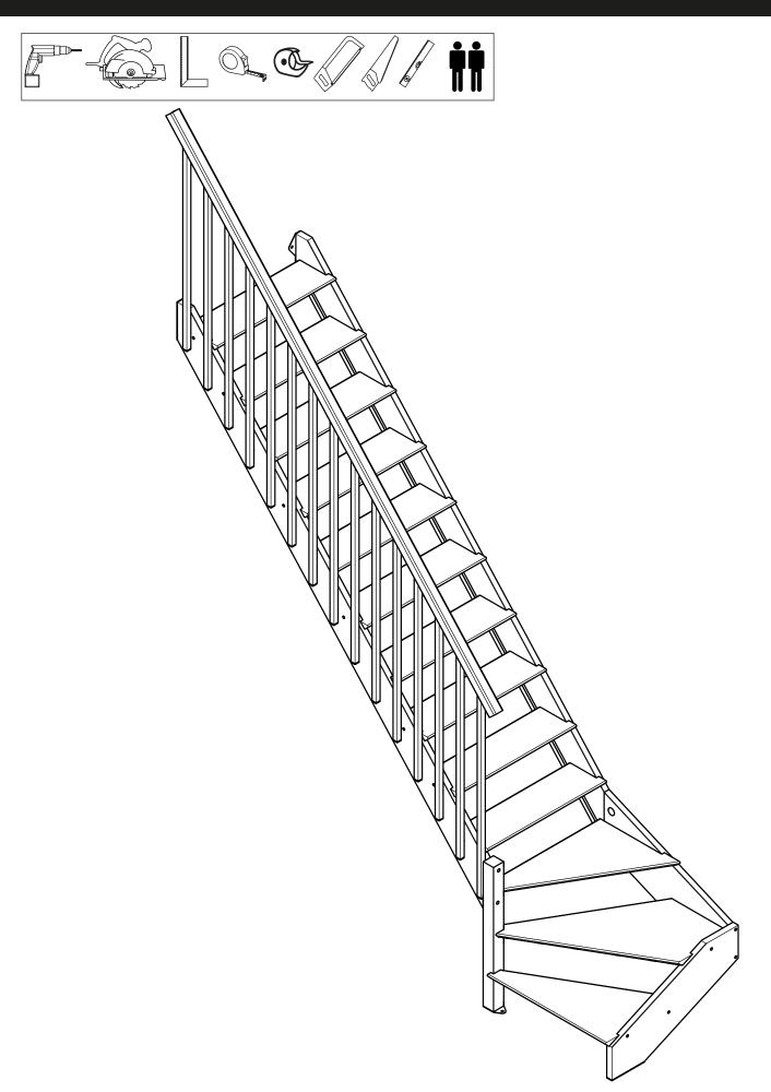
Conçu selon DTU 36.3 et NF EN 15644 (classe de service 1 - traffic F1 - charge par marche maxi 200kg).
