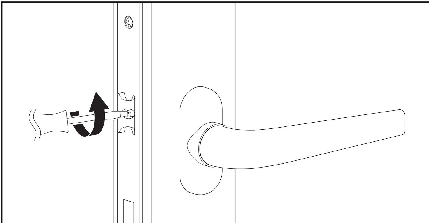
FR Si le portail est automatisé, rétractez le pêne dans la serrure à mortaise en tournant la vis intérieure dans le sens antihoraire.
