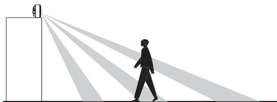
La portée de détection varie en fonction de la hauteur de montage du capteur. Nous recommandons une hauteur de montage de 1,8 m à 2,4 m au-dessus du sol pour une meilleure couverture.
