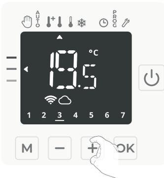
3- Une fois la consigne de température réglée, vous pouvez soit rester dans le mode sélectionné, soit choisir un autre mode par appui sur **M**.
