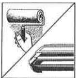
Nur Vlies- oder Spezialleiste laut Herstellerangaben ansetzen und Wand mit Roller bahnweise oder Tapete mit Kleistergerät einkleben.
