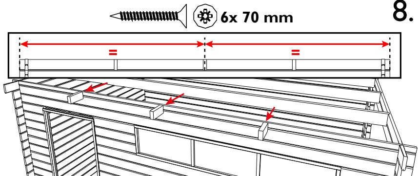
**NL:** Vijs de hulpdakbalkjes P1/0100 telkens met 1 vijs van 70 mm door de zijwand vast in de kop van het blokje. De voorste balkjes verticaal het achterste balkje horizontaal. Hou de bovenkant van blokje gelijk met de schuine zijde van de dakhelling. Verdeel de blokjes symmetrisch over de zijwand.
