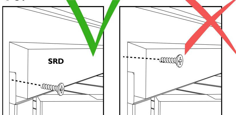
**NL:** Plaats binnen én buiten de sierlat SRD bovenop de kader van de deur. Zij dient om de opening bovenaan te verbergen tijdens het werken van het hout (cfr "hout leeft"). Zet vast met vijzen van 25 mm **op de deurkader**.
