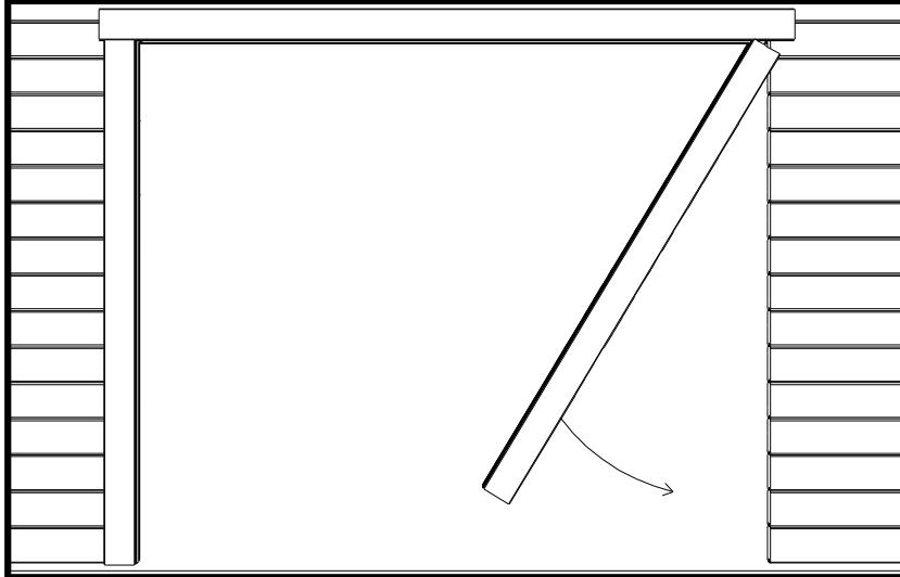
**NL:** Plaats de poortstijlen over de planken, zoals op de tekening. Bevestig op elke poorthelft de bijgeleverde scharnieren. Plaats de scharnieren 15 cm van de boven-en onderzijde en in het midden. Gebruik vijzen van 35 mm. Ga na dat de poorten haaks hangen en vijs de poortstijlen onderaan vast in de plank. Bovenaan vijs u de kaderdelen aan elkaar maar niet in de planken van de wand. Plaats links en rechts van de horizontale kader blokjes om deze bovenaan te blokkeren.
