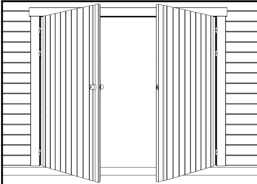
**FR:** Placez le cadre de la porte sur les planches comme sur le dessin. Fixez 2 charnières, l'une à 15 cm du haut, l'autre à 15 cm du bas la troisième étant placée au milieu. Utilisez des vis de 35 mm. Contrôlez que la porte est bien d'équerre et fixez à l'aide d'une vis de 35 mm le cadre en bas à la planche. En haut vissez les pièces du cadre entre elles mais pas au planches de la paroi Vissez une cale à gauche er à droite du cadre horizontal pour fixez celle si.
