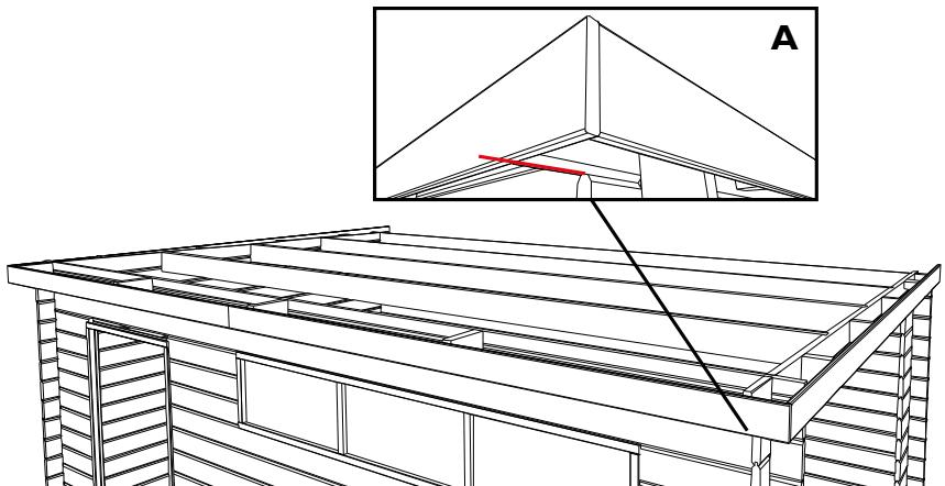
**NL:** Plaats nu de 2de laag frontale sierlatten FSL tegen de eerste laag, laat 5 cm overlappen. Begin opnieuw vooraan. Werk op de zelfde manier als de 1ste laag. Gebruik 5 vijzen van 25 mm per lat om de 2de laag aan de eerste van te maken.
