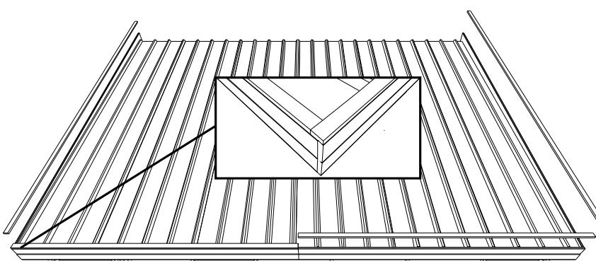
**NL:** Vijs nu de stormsierlatten SSL op de frontale sierlatten FSLM. Gebruik 5 vijzen van 35mm per lat. Begin met de voorste (in 2 delen) en daarna deze aan de zijkant. Deze latten moeten nog op lengte gezaagd worden.
