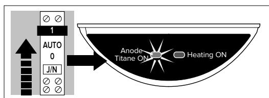
Indien de installatie alleen 's nachts van een elektrische voeding is voorzien, moet u om de bescherming van de kuip te garanderen MINSTENS EENMAAL PER JAAR de werking van het controlelampje voor de bescherming controleren door de elektrische verbinding gelijktijdig in handmatige modus ON te forceren.
