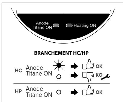
Bei einem Gerät, das nur nachts mit Strom versorgt wird, überprüfen Sie MINDESTENS EINMAL PRO JAHR die Funktion der Schutzanzeige, indem Sie gleichzeitig den Schalter in den manuellen Modus (auf „ON“) schalten, um den Schutz des Tanks zu gewährleisten.
