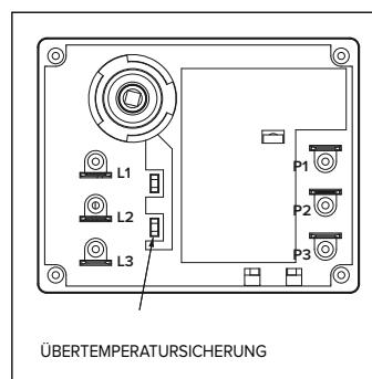
Bei einem Widerstandswert von Null oder Unendlich muss das Heizelement ausgetauscht werden!
