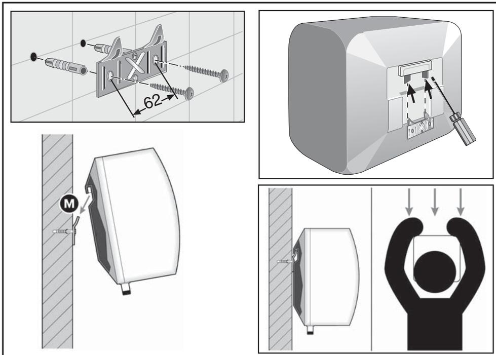
Schema installazione - Installation scheme - Schéma d'installation - Installatie schema - Installations-Schema - Esquema de instalacion Esquema de instalação - Schemat instalacji - Beszerelési rajz - Schéma instalace - Схема установки - Схема установки - Pajungimo schema Uzstādīšanas shēma - Paigaldusskeem - Кондыру схемасы - Nacrt za instaliranje - Инсталационна схема - مخطط التركيب - Schema de montaj
