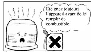
Lorsque vous utilisez l'appareil, aérez la pièce au moins une à deux fois par heure et durant une à deux minutes à chaque fois. N'utilisez jamais l'appareil sans aérer convenablement la pièce dans laquelle il se trouve. Une oxygénation insuffisante peut être à l'origine d'une mauvaise combustion et créer des émanations de monoxyde de carbone hautement toxiques.
