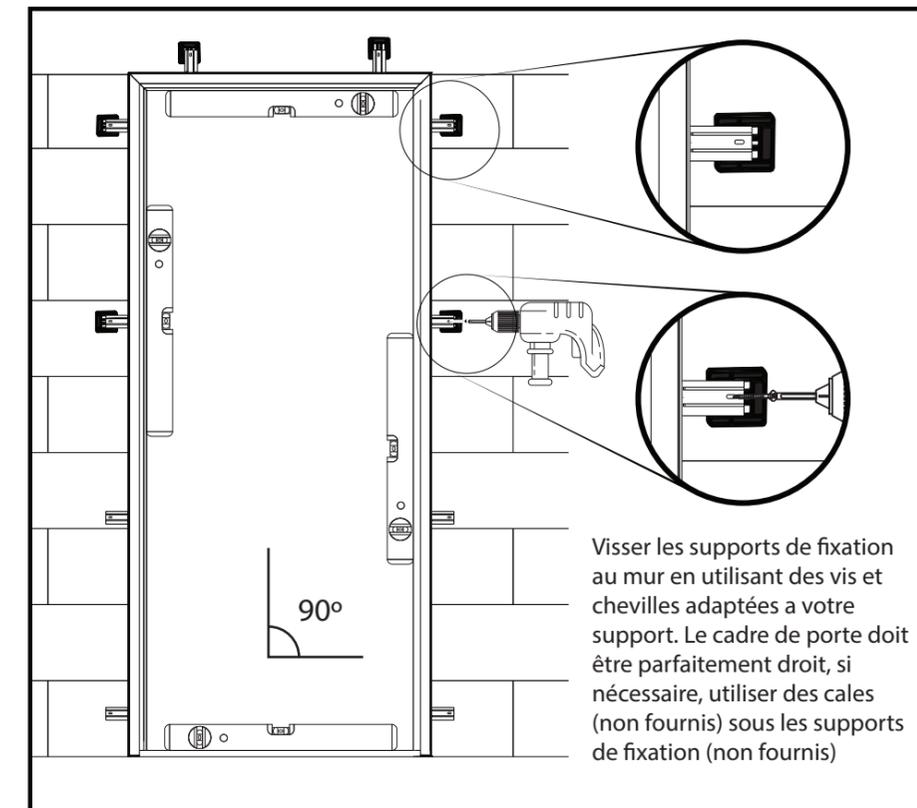
Visser les supports de fixation au mur en utilisant des vis et chevilles adaptées à votre support. Le cadre de porte doit être parfaitement droit, si nécessaire, utiliser des cales (non fournis) sous les supports de fixation (non fournis)
