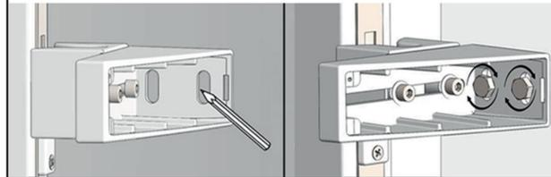
RÉGLEZ L'APLOMB DU PORTAIL PUIZ RESSERREZ LES VIS. FINALEMENT, IL FAUDRA INSTALLER LE CACHE VIS SUR LE SUPPORT.
