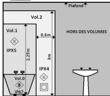
Les luminaires installés dans les lieux humides comme la salle de bain doivent respecter les critères de la norme NFC15-100. Ces luminaires doivent comporter un indice de protection (IPxx) et être installés uniquement dans le volume pour lequel ils sont autorisés. La salle de bain est répartie en 3 volumes.
