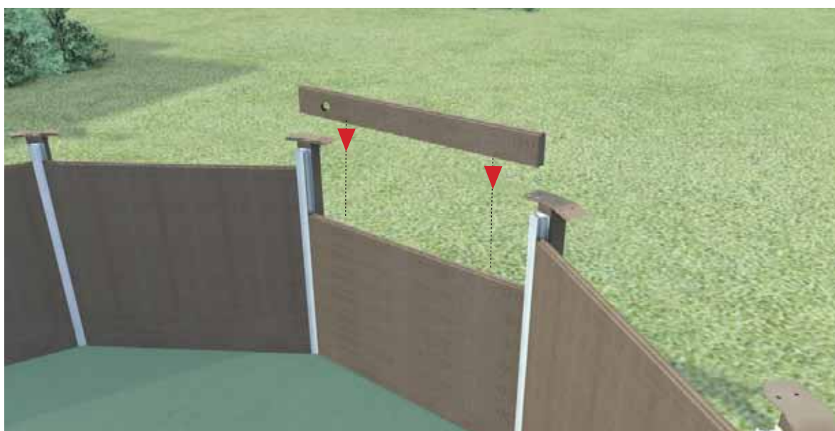
Mise en place de la traverse n° 4.
