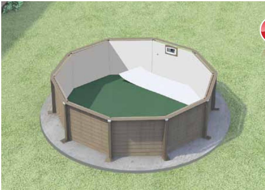
Emplacement du feutre Géotextile
