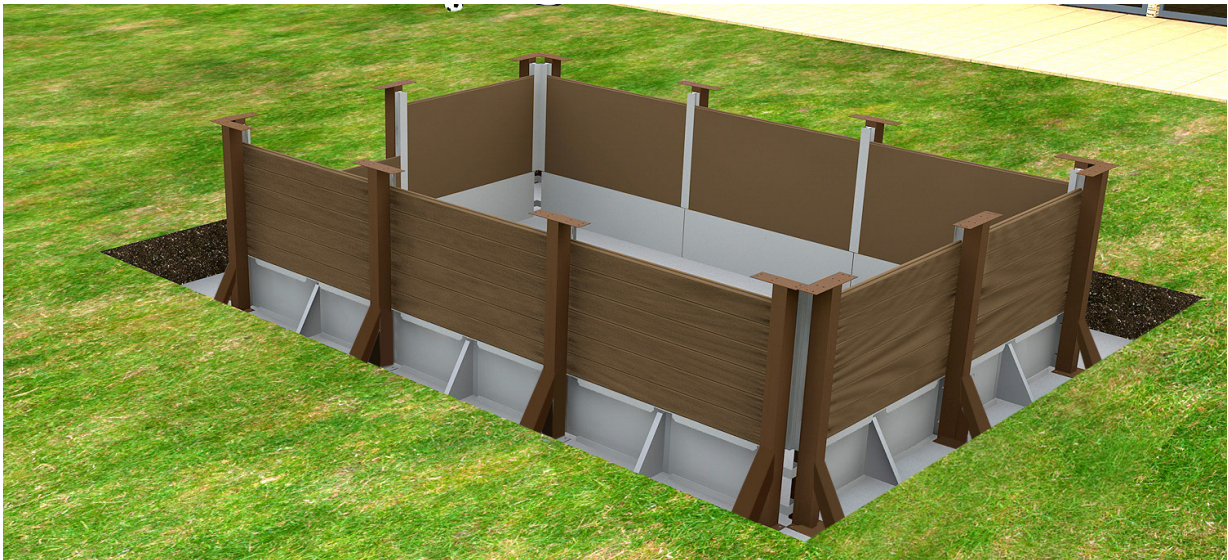
Mise en place de la traverse n° 2 jusqu'à la 6ème rangée.
