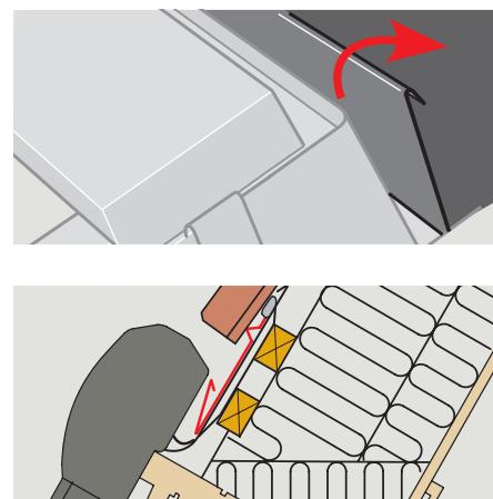
**NEDERLANDS:** Als het rolluik wordt geplaatst op een dakraam dat is ingebouwd met het gootstuk EDJ of EDN: Buig de afvoergoot naar beneden om ruimte te maken voor het rolluik.
