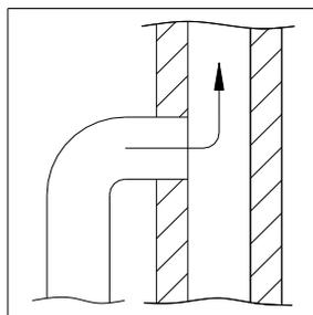
Le poêle peut être raccordé à un conduit auquel d'autres sources de chaleur sont connectées.
