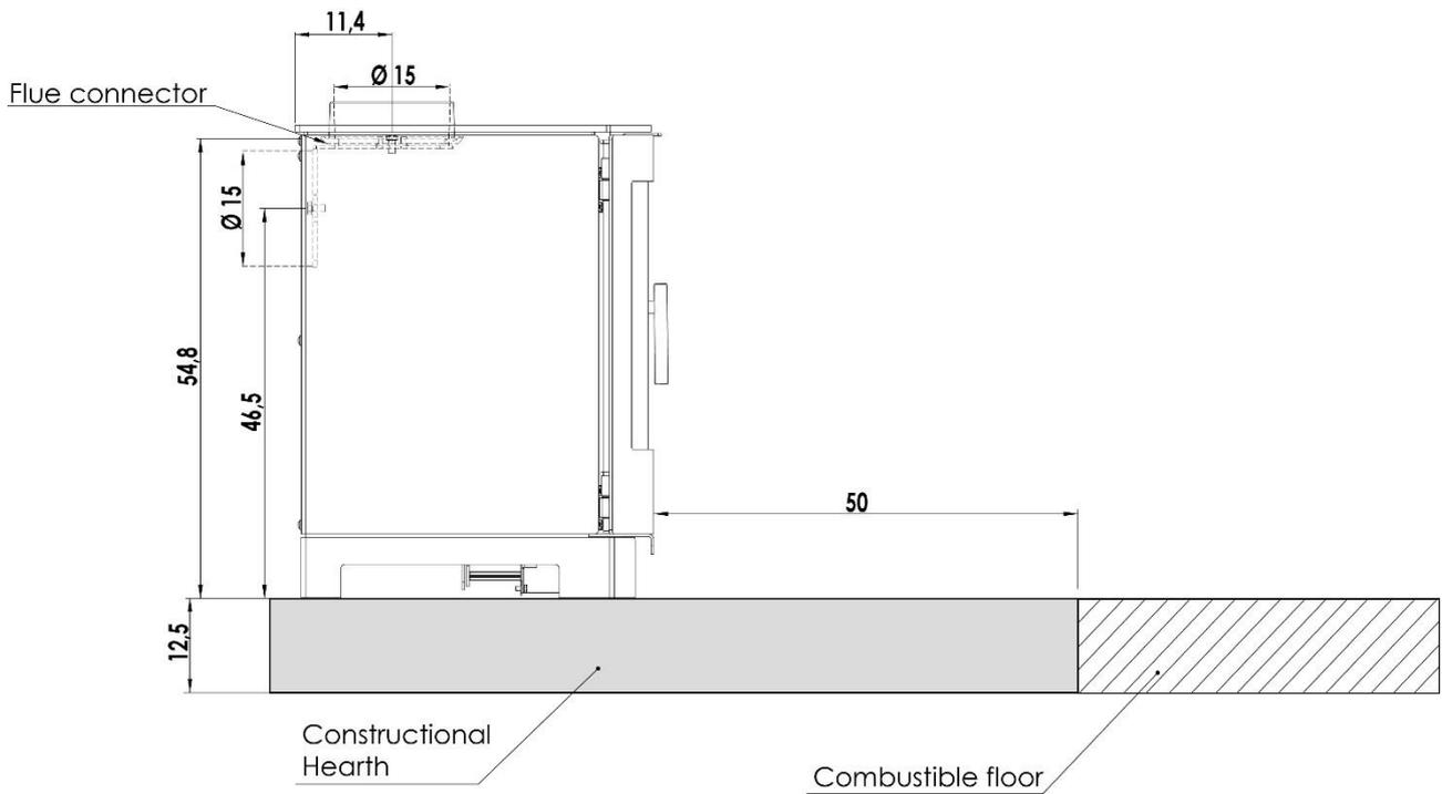
Pour pouvoir placer un poêle sur un matériau inflammable comme p.ex. un plancher en bois ou une moquette, il est nécessaire d'utiliser un support intermédiaire non inflammable. La grandeur de la plaque de
