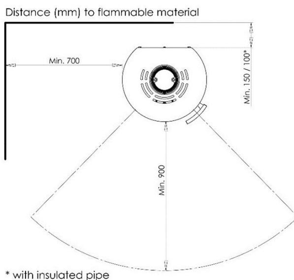
Pour pouvoir placer un poêle sur un matériau inflammable comme p.ex. un plancher en bois ou une moquette, il est nécessaire d'utiliser un support intermédiaire non inflammable. La grandeur de la plaque de
