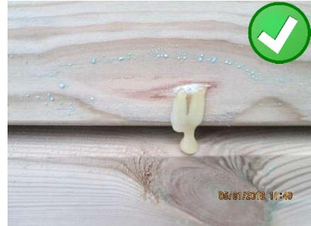
Des coulées de résine apparaissent à la surface du bois sous la forme des taches collantes ou de fuites jaunes ou blanches. C'est un phénomène naturel des résineux. Le facteur propice à leur apparition est la température élevée. Il est conseillé de les retirer à l'aide d'une spatule et du résidu à l'aide de solvants non agressifs (essence de nettoyage, térébenthine, ammoniac, nitro solvant).
