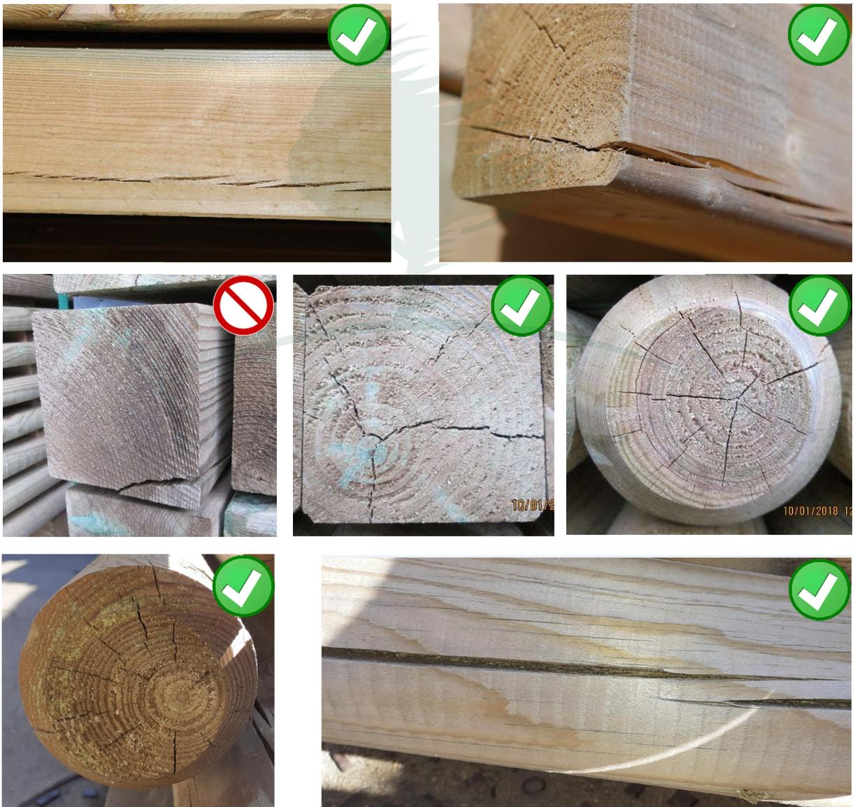
La fissure est une rupture du tissu de bois le long des fibres, résultant généralement du séchage du bois ou d'une chute soudaine de la température (la gelée). Les fissures les plus visibles se produisent dans les produits contenant la moelle.
