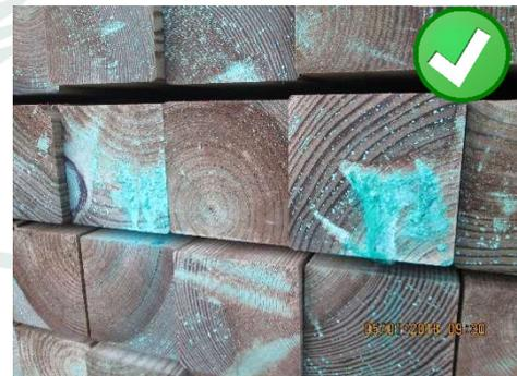
Des remontées de sel se manifestent à la surface du bois sous la forme des taches blanches. Elles peuvent être facilement enlevées à l'aide d'un produit de nettoyage dilué dans l'eau, par exemple de liquide vaisselle.
