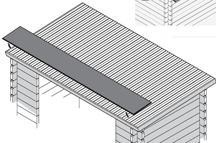
Coupez une bande de feutre bitumeux de la largeur du toit de façon à recouvrir les planches de rive A4 - B3 et C4. Laissez dépasser légèrement (environ 1 cm).
