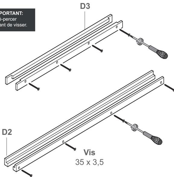
Assemblez les deux montants et la traverses à l'aide des vis 3,5 x 35 fournies.
