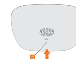
3. Testez votre détecteur de fumée en appuyant sur la surface pendant cinq secondes (C). Lorsque le détecteur de fumée émet une alarme sonore, cela signifie que le test a réussi. Refaites un essai 30 minutes après afin de vous assurer que le détecteur de fumée est solidement fixé au plafond. L'installation est désormais prête. Testez votre détecteur de fumée chaque semaine!
