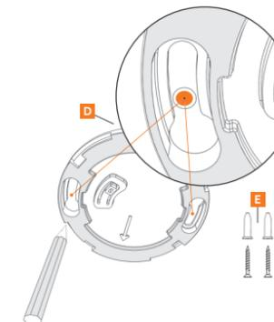
2. Tracez des repères pour les trous de vis. (D). Vous pouvez orienter votre détecteur de fumée à l'aide de la flèche directionnelle. La flèche directionnelle doit pointer dans la même direction que les côtés du détecteur de fumée.
