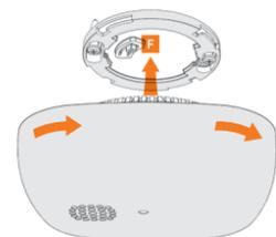
4. Pressez le détecteur de fumée contre la plaque d'installation (F) puis tournez cette dernière dans le sens des aiguilles d'une montre jusqu'à ce que quatre clics retentissent. Veuillez noter que la plaque d'installation ne pourra pas être fixée au détecteur de fumée en l'absence de piles ou lorsque ces dernières n'ont pas été correctement installées.
