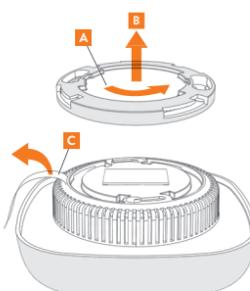
1. Retirez la plaque d'installation du détecteur de fumée en la tournant dans le sens inverse des aiguilles d'une montre (A) puis en la soulevant (B). Tirez le ruban rouge de protection des piles afin de le retirer (C).
