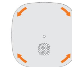
5. Vous pouvez changer légèrement la position du détecteur de fumée en le tournant de quelques degrés dans le sens souhaité.
