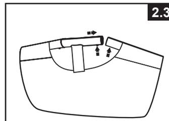
La dernière pièce en T peut être difficile à installer, mais peut se faire facilement en soulevant simultanément la dernière pièce en T et la poutre de plus de 5cm, puis en insérant la poutre dans la pièce en T tout en abaissant les pièces dans la bonne position. La poutre s'enfilera dans la pièce en T (voir dessin 2.3). Assurez vous que la dernière poutre est complètement assemblée avant d'emboîter les pieds.
