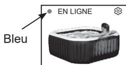
« EN LIGNE » avec un point bleu à l'avant → L'appareil portable et le panneau de contrôle du spa sont appariés avec succès mais non au même signal de routeur WiFi.
