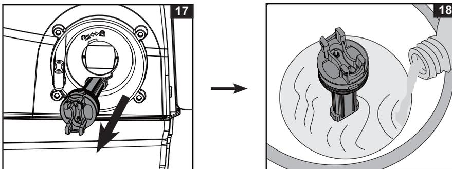
6. Retirez la cellule électrolytique et rincez les plaques à l'eau douce. Attention : Conservez la partie connexion de la cellule électrolytique complètement sèche, ne la laissez pas entrer en contact avec le vinaigre et l'eau.
