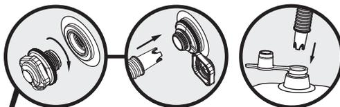
Vissez la soupape à vis sur les soupapes d'entrée d'air affichant le n° 1 sur la couverture en similicuir.
